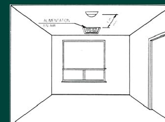
Installez l'avertisseur à 1 mètre (39,37 pouces) d'un conduit de ventilation ou d'un ventilateur.
